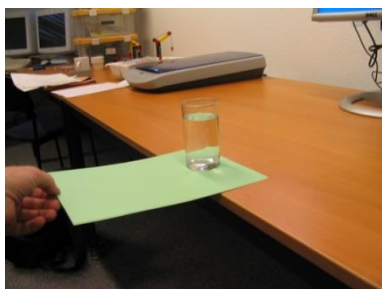
Figuur 3 – Traagheid: het glas water verzet zich tegen versnelling (een ruk).
